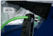
12. Streifen Sie nun die Drahtlitze über das Unterteil des BNC Steckers.
