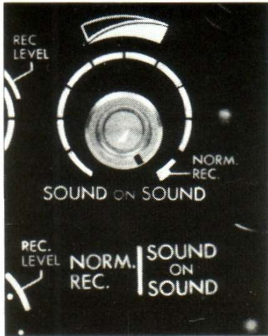
① Trickblende-Knopf auf NORM.-REC drehen
